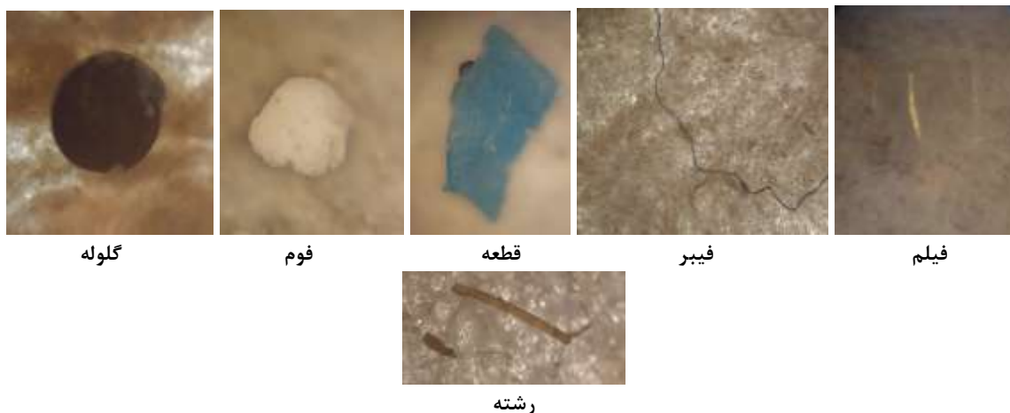
شکل ۲- تصاویر ذرات میکروپلاستیک موجود در رسوبات رودخانه زاینده‌رود با استفاده از میکروسکوپ دوچشمی نوری
