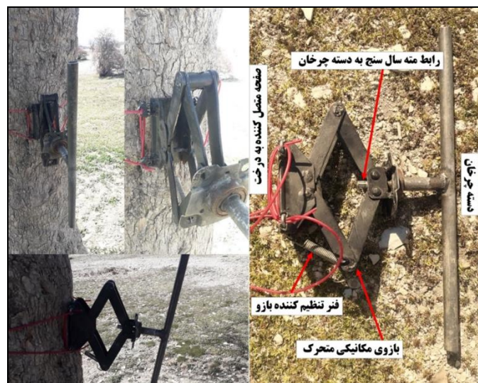
شکل ۳- مته سال‌سنج ارتقا یافته و چگونگی نمونه‌برداری با آن
