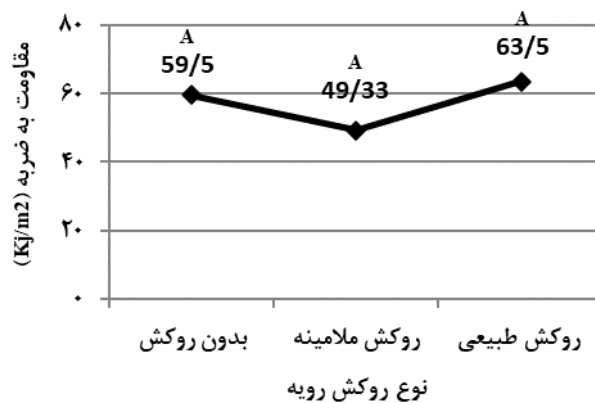
شکل ۵- اثر استفاده از رویه با روکش مختلف بر مقاومت به ضربه پانل‌های ساندویچی ساخته‌شده با مغزی پلی‌اتیلن شبکه‌ای
