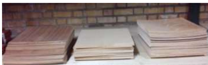
الف) تخته فیبر ۳ mm از راست به چپ: با روکش طبیعی، بدون روکش، با روکش ملامینه
