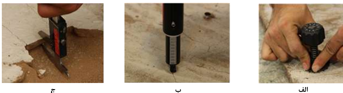
شکل ۱- (الف) دستگاه برش پره مورد استفاده در این مطالعه، (ب) دستگاه نفوذسنج جیبی مورد استفاده در این مطالعه (ج) اندازه گیری ضخامت سله به وسیله کولیس
